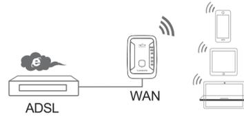
1. Le mode doit être réglé sur la position « Router » pour le mode routeur.
